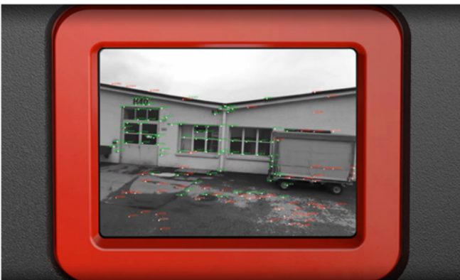
図 7 Visual SLAM 技術により特徴点を捉えるイメージ (GS18 I)
